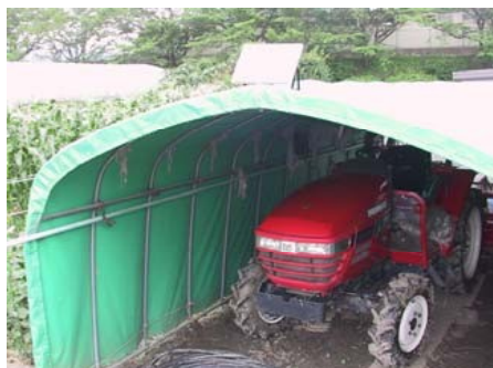
冬場、トラックターのバッテリーの維持充電に。
