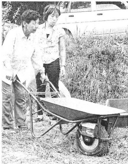
車輪に内蔵したモーターで荷物を運ぶ手押し車(いずれも昨年11月、下市町で=三晃精機提供)
