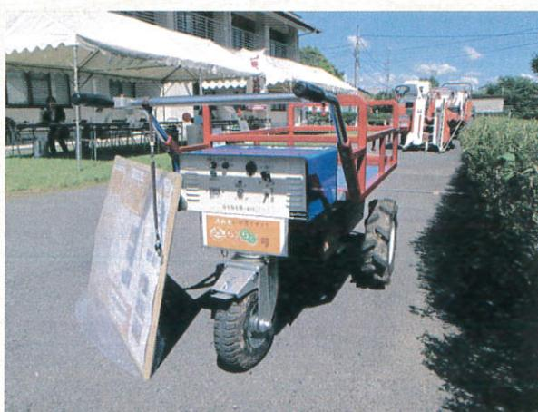
資料：開発した柿果実運搬のための電動農作業車
